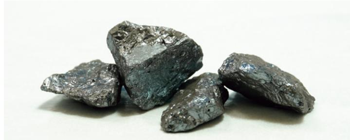
元素名: Silicon, 原子番号: 14, 原子量: 28.09, 電子配置: [Ne]3s<sup>2</sup> 3p<sup>2</sup>, 密度: 2.329 Mg·m<sup>-3</sup>(293 K), 結晶構造: ダイヤモンド形構造(~1687 K)<sup>(1)</sup>, 融点: 1687 K<sup>(2)</sup>, 地殻存在量: 60.6 mass% (SiO<sub>2</sub>換算)<sup>(3)</sup> 【写真】金属シリコン(田鍋恭大写真提供)
