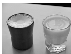
図2 飲むヨーグルトをマグネシウム製のぐい呑み(左)とガラス製のぐい呑み(右)に注いだ様子。マグネシウム製のぐい呑みからは水素が発生し、酸味が和らぐ。
