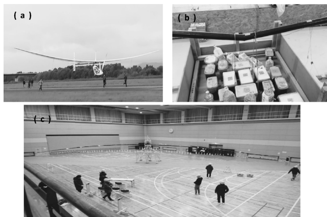
図1 (a)Northern Wings の人力飛行機. (b)破壊試験と(c)荷重試験の様子.
