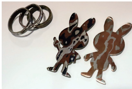
図1 木目金と煮色着色で作った指輪(左)と千葉工大キャラクターのチバニー(右)。(オンラインカラー)
